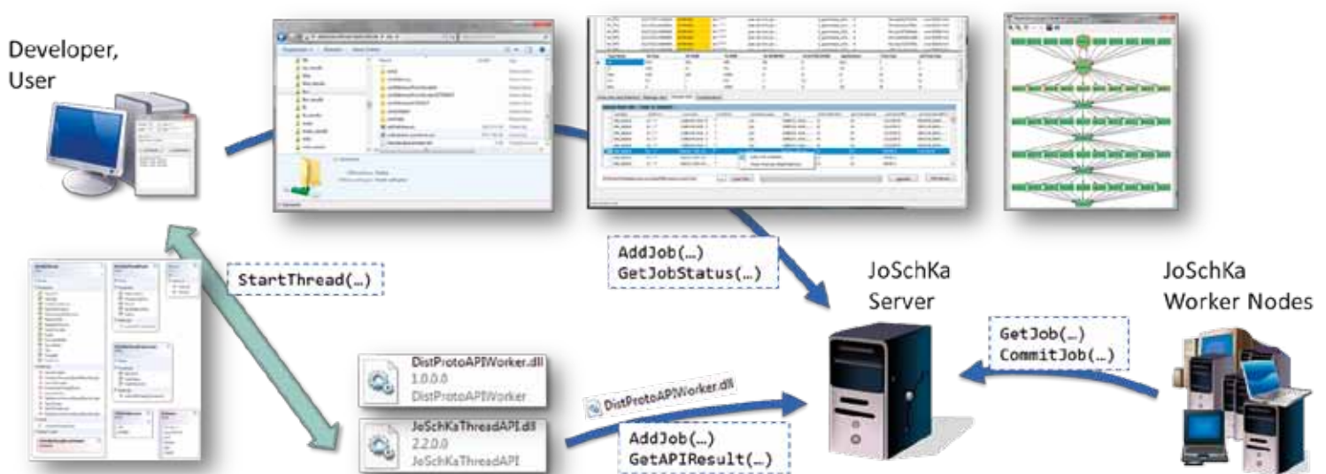
Abbildung 2: Möglichkeiten der Nutzung von JoSchKa (Server-Netzwerkdateisystem, grafisches Frontend, Modellierung von Jobabhängigkeiten und/oder Programmierschnittstelle mit automatischer Programmcodeübertragung) und das Zusammenspiel von Nutzer, Server und den Agenten auf den Rechenknoten im Überblick. Für weitergehende Informationen sei auf [5] verwiesen.
