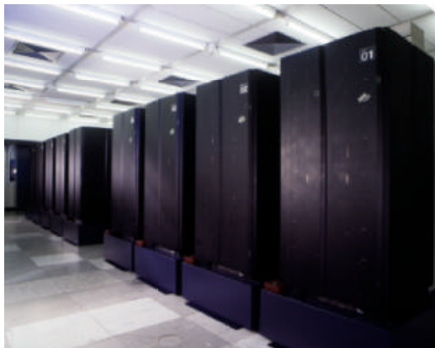
256-Knoten-Parallelrechner IBM RS/6000 SP am RZ mit 120 Giga Byte Speicherkapazität
