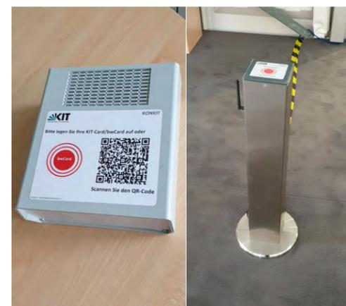
Abbildung 2a und 2b: Gehäusevarianten der KONKIT-Box
