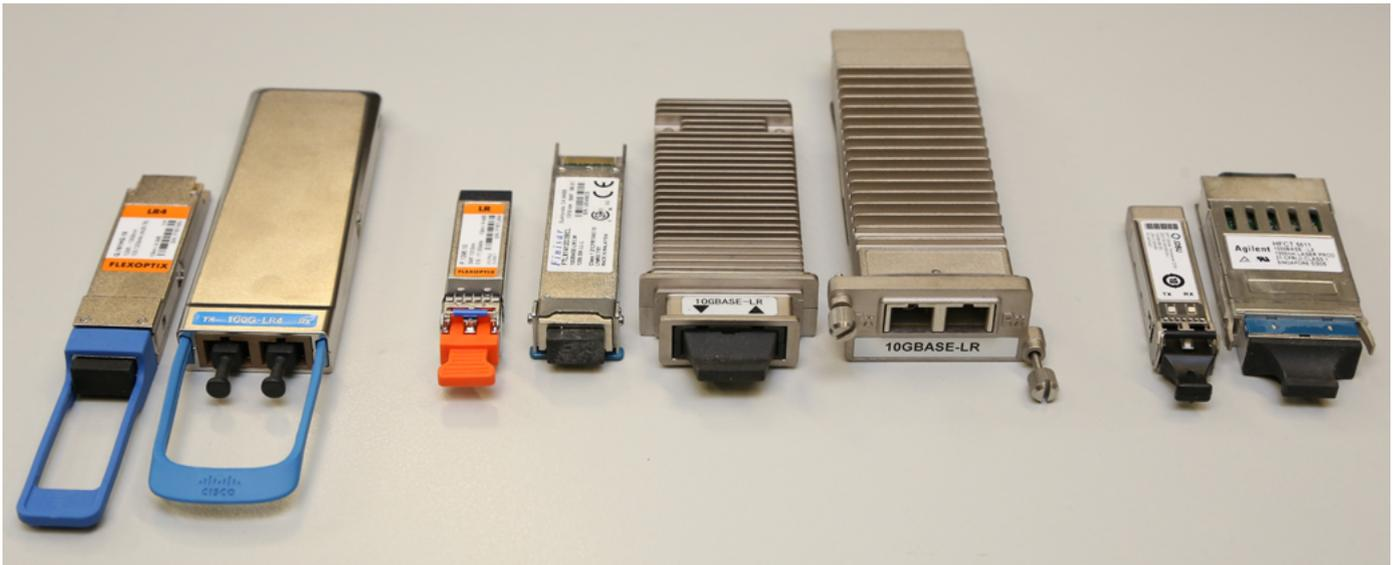
Abb. 2: Evolution der Transceiver 1G, 10G, 100G
