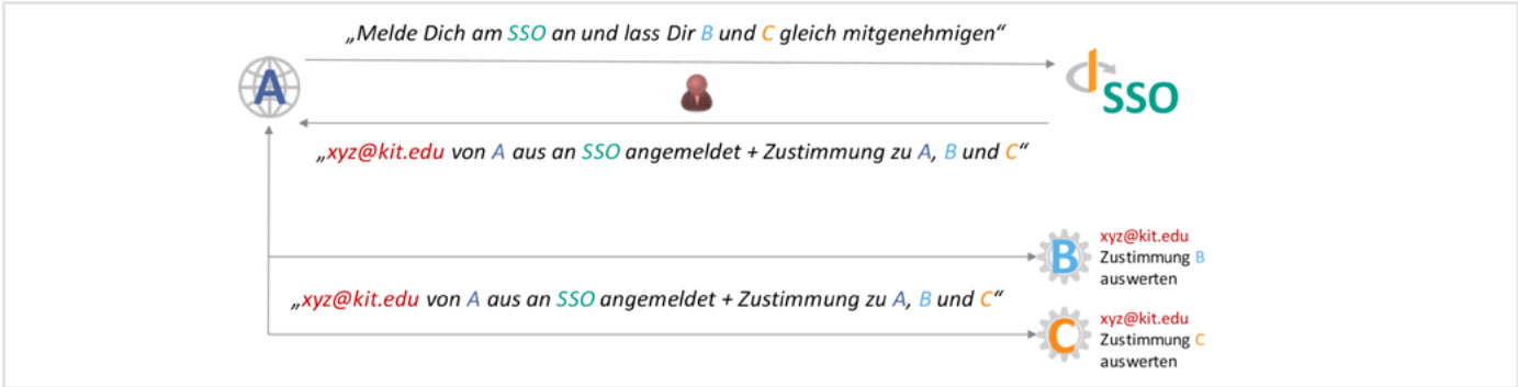
Abb. 1 : Typischer Anwendungsfall einer Authentifizierung mit OpenID Connect/OAuth2
