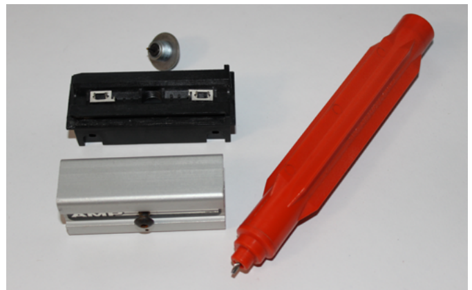
Abb. 2: Vampire Tap mit Mittelkontakt und Bohrwerkzeug
