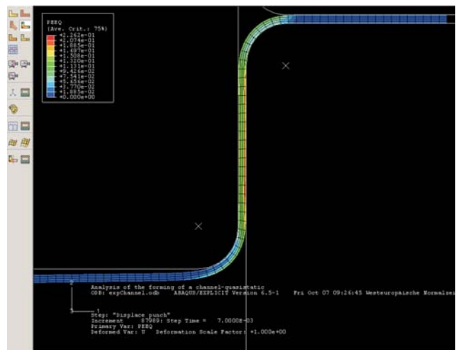
Abb. 2: Endzustand des Verformungsprozesses. Als Konturplot ist die plastische Dehnung im Blech dargestellt.
